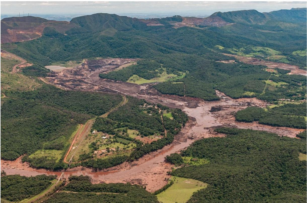
**Figura 1.** Mina do Córrego do Feijão (Brumadinho, MG) e área acometida pela lama de rejeitos de minério, após ruptura da barragem em 25 de janeiro de 2019. Foto: Vinícius Mendonça / Ibama. Fonte: <https://creativecommons.org/licenses/by-sa/2.0>.
